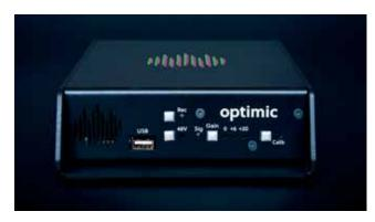
Über eine integrierte KI wird das Sprachsignal entstört. Es können Hintergrundgeräusche und Raumhall stufenlos leiser geregelt werden. Dies passiert in Echtzeit und bedarf keiner individuellen Einmessung. Der Optimic regelt automatisch die Vorverstärkung in Abhängigkeit vom Pegel des eingehenden Signals in einem einstellbaren Regelbereich. Zusätzlich verfügt er über einen adaptiven EQ, der die Sprachverständlichkeit optimiert.
